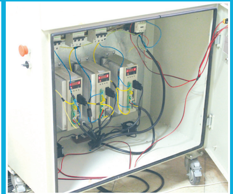
▲ واحد کنترل و تامین توان الکتریکی ربات تریپترون
