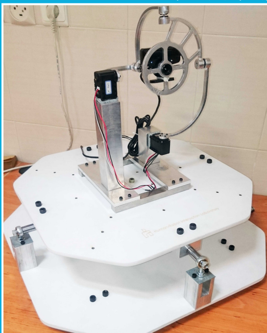
▲ ربات ۲ درجه آزادی چشم جابک نصب شده بر روی صفحه رباتیک لغزان - حمایت شده توسط هوانا
